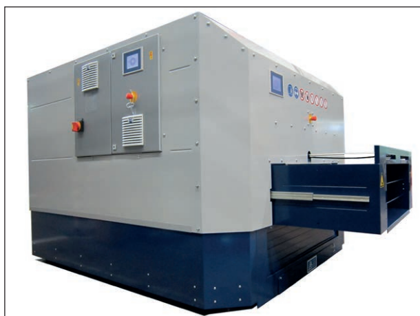
Fahrtwind-Simulator Typ VQF 630/1400, Ausblas- und Bedien-seite
