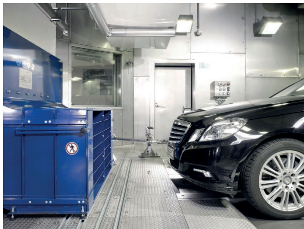
Fahrtwind-Simulator Typ VQF 1000/1600, Ausblasseite
