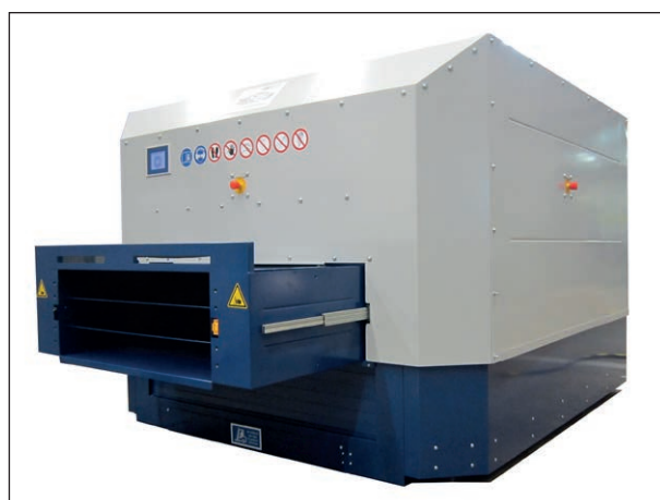
Fahrtwind-Simulator Typ VQF 630/1400, höhenverstellte, aus-fahrbare Ausblasdüse
