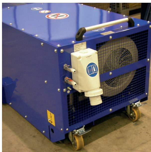
Fahrtwind-Simulator Typ VQF 500/800 für Fahrzeug-Rollenprüfstände, Antriebsseite mit elektrischen Anschlüssen
