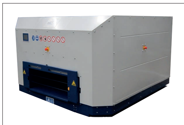
Fahrtwind-Simulator Typ VQF 630/1400, Ausblasseite.
