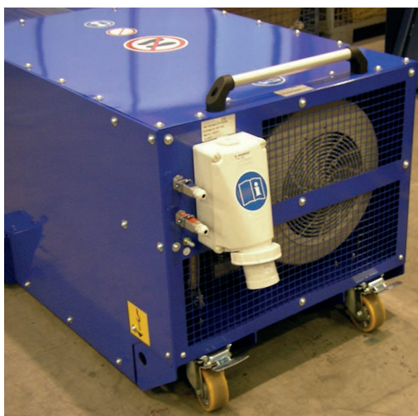
Fahrtwind-Simulator Typ VQF 500/800 für Motorrad-Rollenprüfstände, Antriebsseite mit elektrischen Anschlüssen
