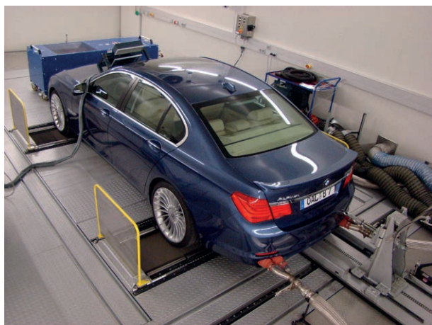
Fahrtwind-Simulator Typ VQF 500/800
