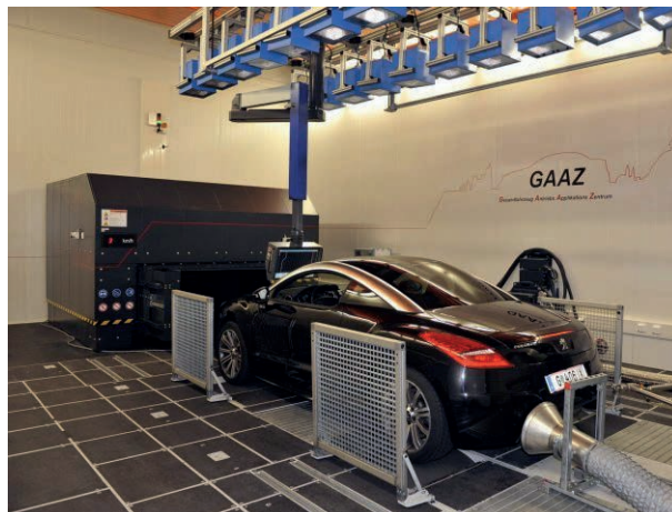
Fahrtwind-Simulator Typ VQF 1000/2000
