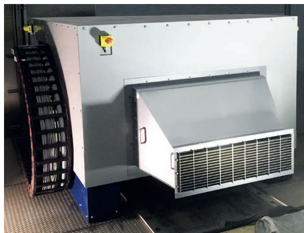
Fahrtwind-Simulator Typ VQF 800/1250, mit höhenverstellbarer, ausfahrbarer Ausblasdüse
