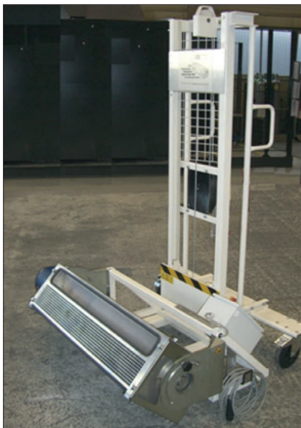
Fahrtwind-Simulator Typ VQF 200/1000
