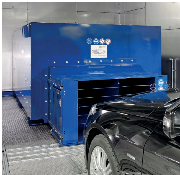
Fahrtwind-Simulator Typ VQF 1000/1600, Ausblasseite
