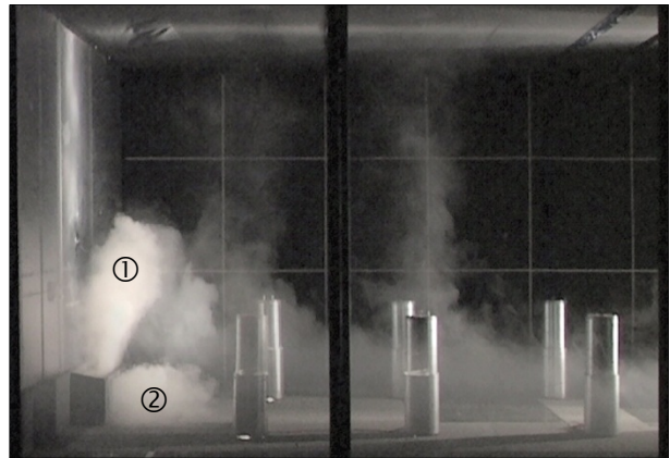
HFVsf-.../MQQ im Kühlfall: Komfortable Raumströmung auch bei 100 m³/h Primär- luft-Volumenstrom. ① Misch-/Quellströmung ② Quellströmung
