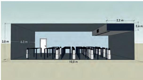
Abb. 6: Raumströmungsversuch mit einem Schulraum
