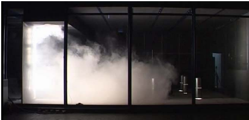
Abbildung 4 : Laborversuch für einen Schulraum mit Misch-Quelllüftung
