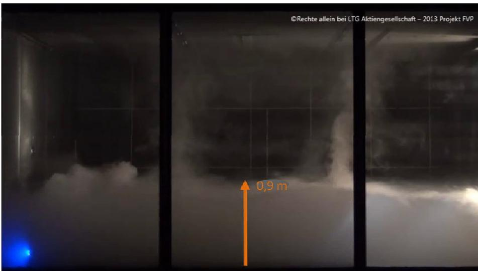
Abbildung 5: Ansicht: Fassade bei  $x=0$ ; Visualisierung einer instationären Raumluftrömung im Kühlfall bei einer Zykluszeit von 40 Sekunden; Die Höhe des gekühlten Luftvolumens beträgt etwa 0,9m bei einer Untertemperatur von 8K
