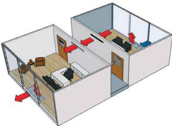
Prinzip der Querlüftung (Bild: LTG)
