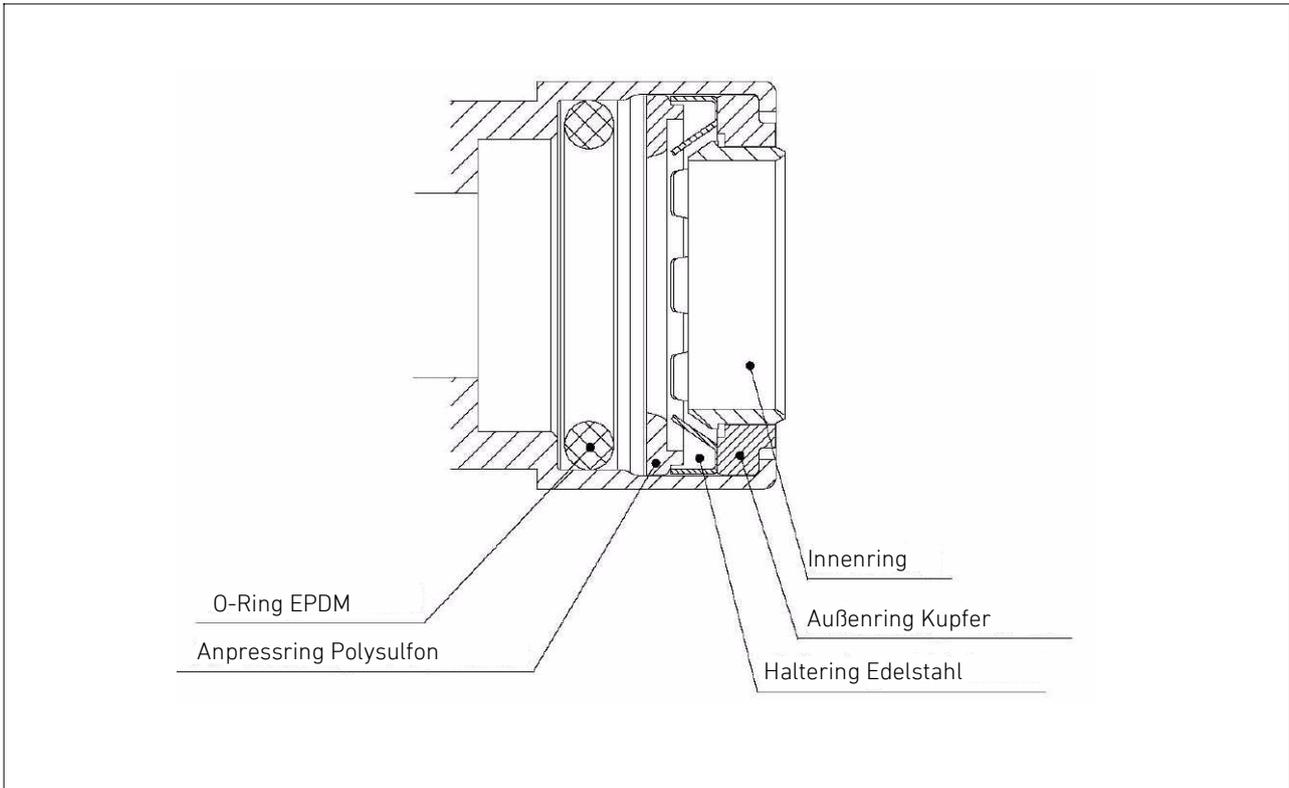
Rohrverbindung aus Steckfitting und blankem Kupferrohr gemäß EN 1057 und RAL 641/1 bzw. dafür geeignetem Rohrstützen aus Messing oder Rotguss.
