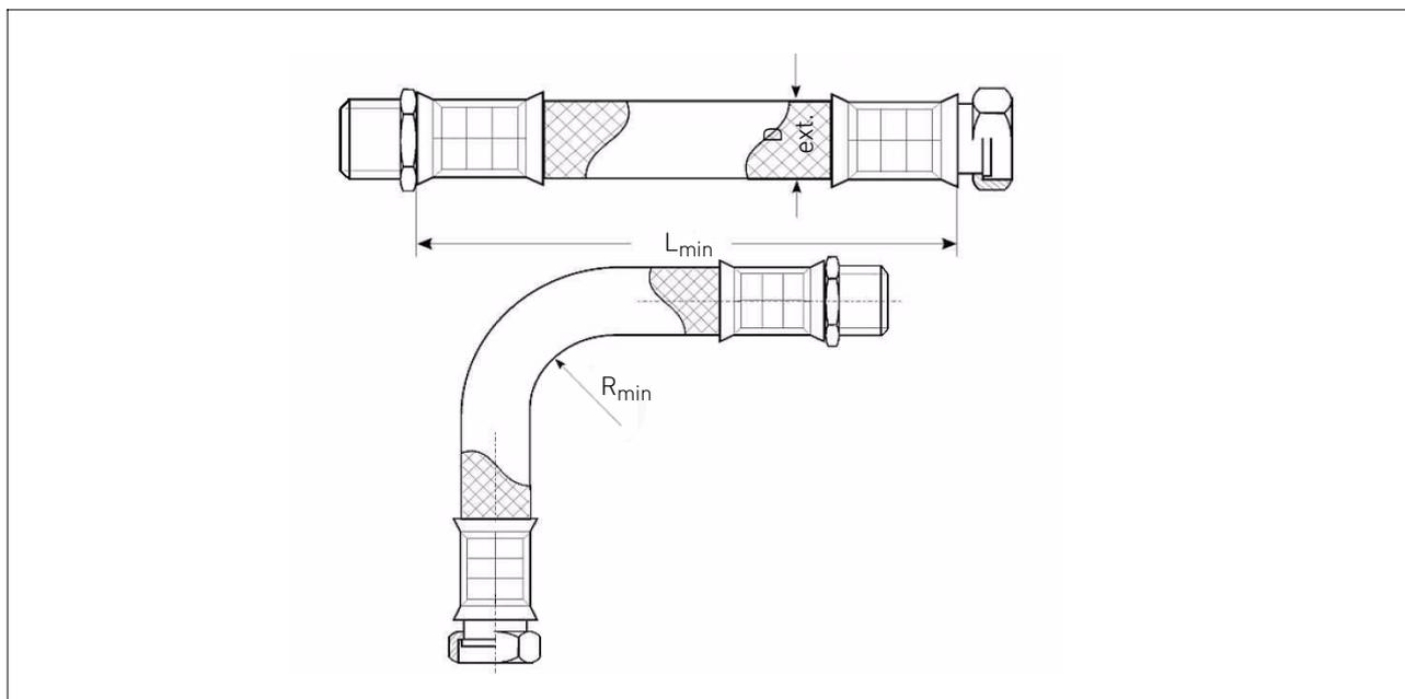
**Panzerschlauch bis +80 °C** (sauerstoffdiffusionsdicht, Kennzeichnung blauer Flechtstreifen)
