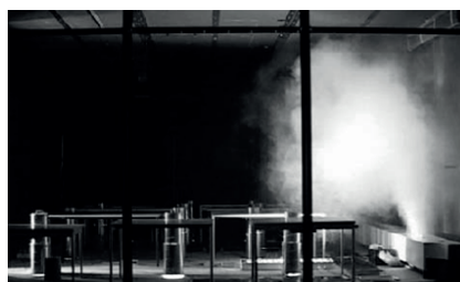
Raumströmung von Induktionsgeräten Typ HFG mit Fächereinsatz für Misch-Quellströmung (Rauchaufnahme in drei Zeitschritten)
