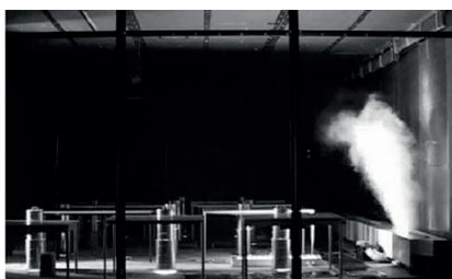
Raumströmung von Induktionsgeräten Typ HFG mit Fächereinsatz für Misch-Quellströmung (Rauchaufnahme in drei Zeitschritten)
