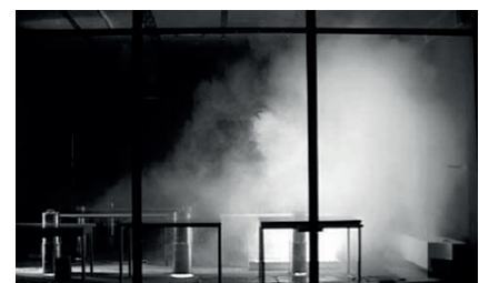
Raumströmung von Induktionsgeräten Typ HFG mit Fächereinsatz für Misch-Quellströmung (Rauchaufnahme in drei Zeitschritten)
