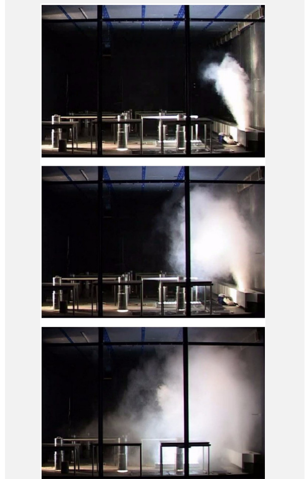
LTG Raumströmungstechnik: zugfreie Misch-Quellströmung durch abgestimmten Fächereinsatz
