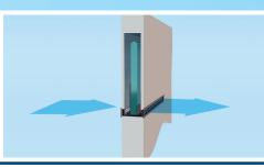
Der Überströmdurchlass LDO-T lässt Luft zwischen zwei Räumen frei strömen und gleicht Druckdifferenzen aus, verhindert aber gleichzeitig die Übertragung von Geräuschen und Sprache (Telefonieschalldämpfung).
